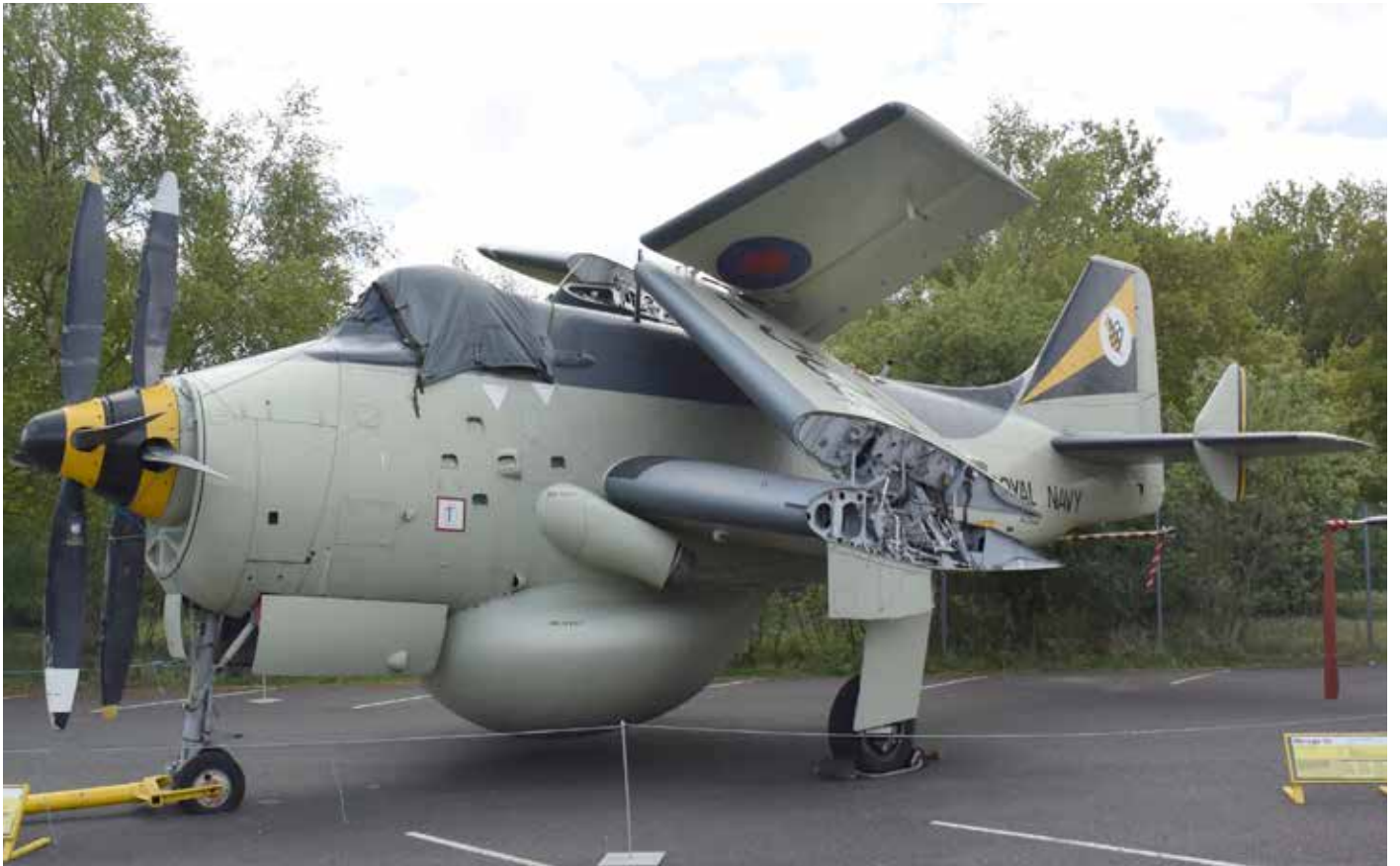
Massiivinen, Double Mamba- potkuriturbiinimoottorilla varustettu Fairey Gannet AEW 3. Koneen alla oleva ”möykky” pitää sisällään merivalvontatutkan, kone on täysin tukialuskelpoinen.
