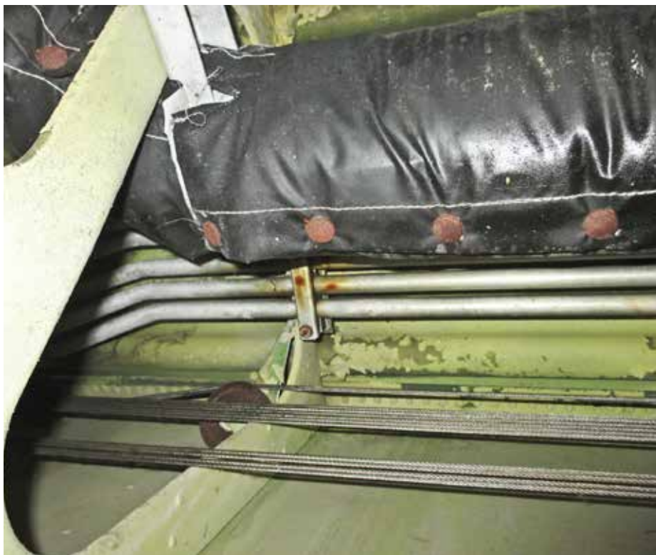
Moottorin ja potkurin ja telinelukituksen vaijerit.
