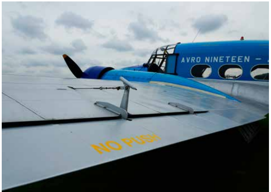
Avro 19 siivekevastapaino. Avro 19 aileron balance horn.
